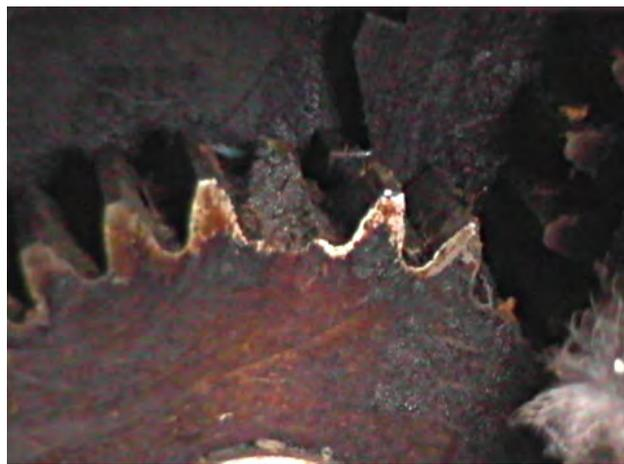
**Izquierda: engranaje reventado; derecho: diente roto en el engranaje *Angelus*** a las 6 am, 12 m y 6 pm respectivamente. Su vida útil, si se le da el debido mantenimiento, es de por lo menos doscientos años, sin necesidad de reparaciones mayores. Aparte de esta belleza melódica, el reloj puede repicar las campanas o ejecutar melodías sencillas, según sea programado para eventos festivos o fúnebres. De manera inexplicable la maquinaria del reloj fue dañada.
