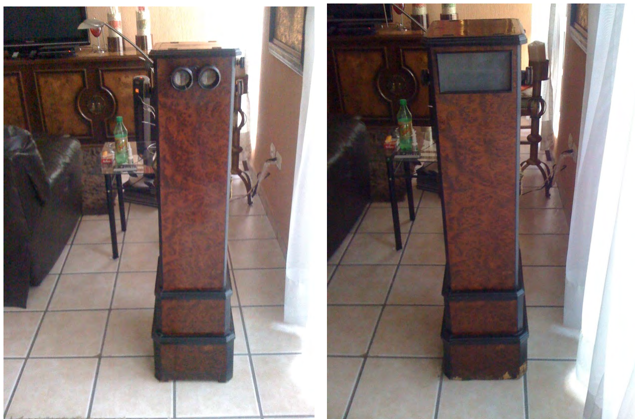
Estereografo de 1857, a la izquierda el ocular; a la derecha, la ventana esmerilada donde entra la luz.
