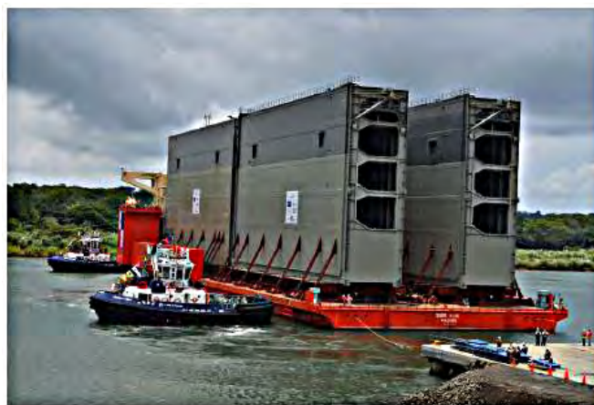
Compuertas rodantes diseñadas por SBE para el tercer juego de esclusas de Panamá.
