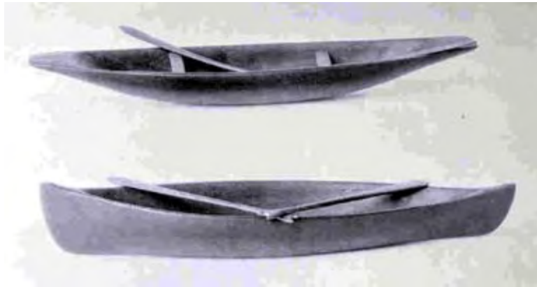
Arriba, modelo de pipante, una canoa de fondo plano para navegar en ríos; abajo, dori, una canoa con quilla para navegar en el mar y las lagunas. Sumus del curso inferior del río Escondido. Reproducido de la obra citada de Conzélius.
