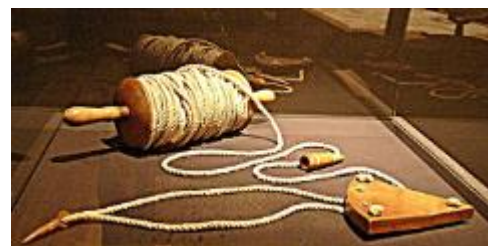
Figura 4. Corredera para medir la velocidad del barco
