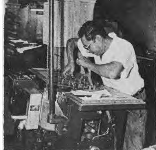
Una tituladora Ludlow funde letras y lingotes en diferentes medidas y caracteres, bajo Enrique Mayorga.
